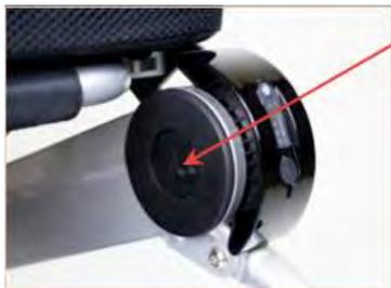
A l'aide du bouton pression, Les batteries peuvent être retirées pour les recharger en dehors du fauteuil.
